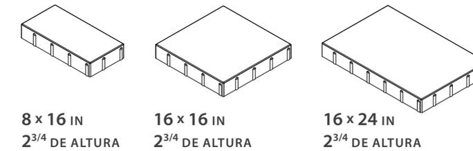
8 x 16 IN 2<sup>3/4</sup> DE ALTURA    16 x 16 IN 2<sup>3/4</sup> DE ALTURA    16 x 24 IN 2<sup>3/4</sup> DE ALTURA
